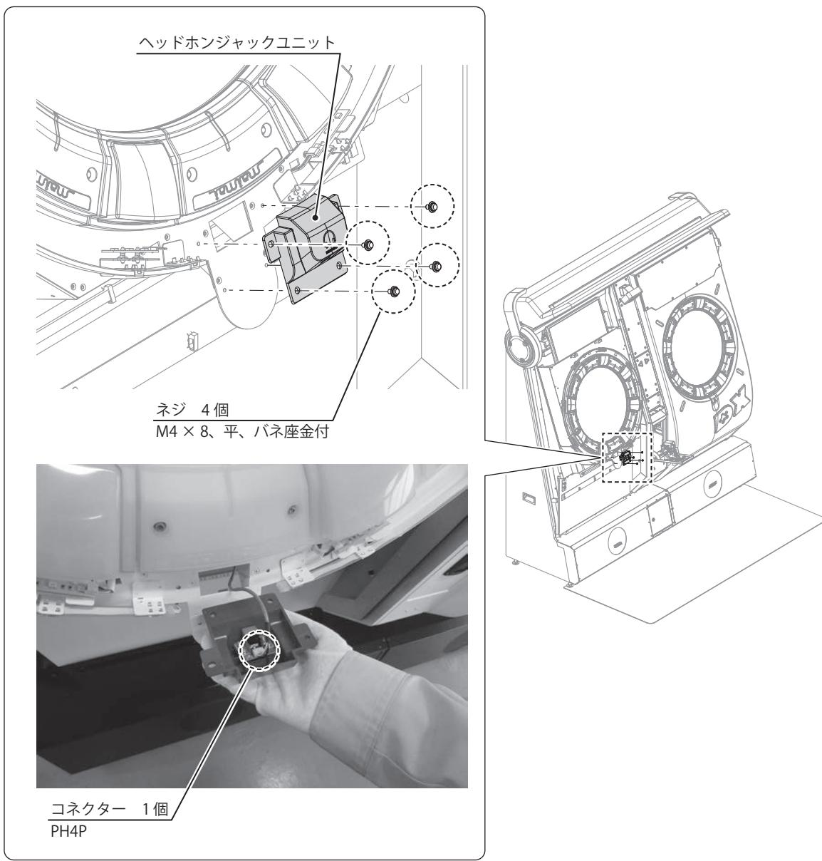
**3** ネジ 4 個を外し、ヘッドホンジャックホルダーとヘッドホンジャックボードを取り外します。
