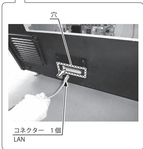
7 手順6で穴に通したLANケーブル50mのコネクター1個を、ルーターユニットのWANポートに接続します。
