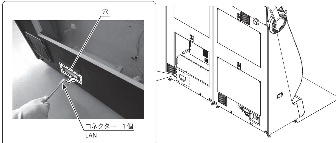
4 手順3で穴に通したLANケーブル10mのコネクター1個を、ALLS HX2に接続します。
