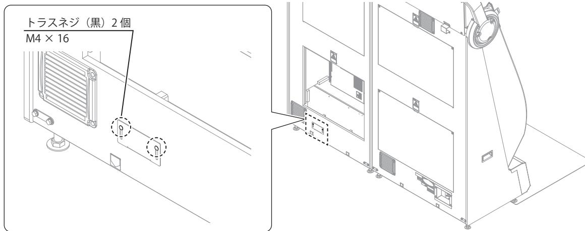
2 LAN リッドを上にスライドし、手順 1 で緩めたトラスネジ 2 個を本締めして固定します。
