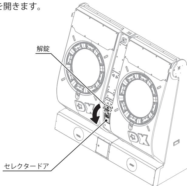
**5** セレクタードア内部にあるキー（キャッシュボックスドア用）で解錠し、キャッシュボックスドアを開きます。
