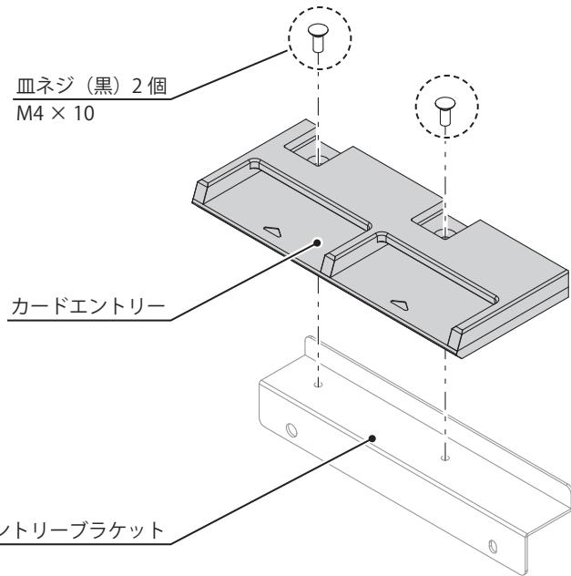
5 ト拉斯ネジ 2 個で、カードエントリーユニットを取り付けます。
