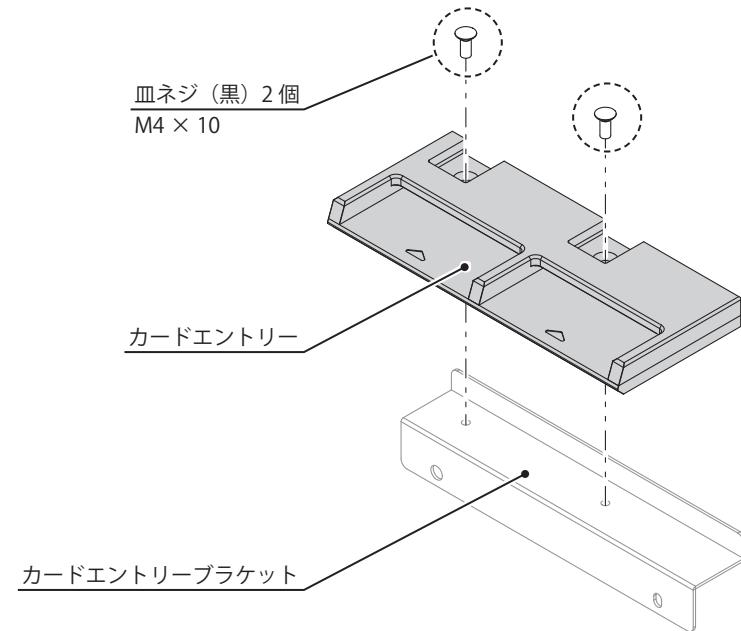
**3** カードエントリーとカードエントリーブラケットのカードが接触する面を清掃します。
