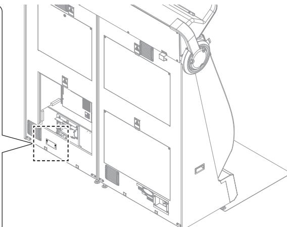
5 LAN リッドを上にスライドし、手順 4 で緩めたトラスネジ 2 個を本締めして固定します。
