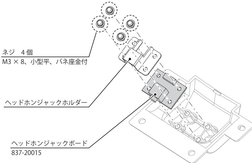
**4** 手順 2 と 3 を参照し、逆の手順で交換するヘッドホンジャックボードを取り付け、組み立て直してください。
