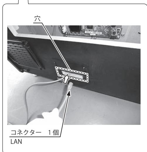
3 手順2で通したLANケーブルのコネクターを、ルーターユニットの空いているLANポートに接続します。
