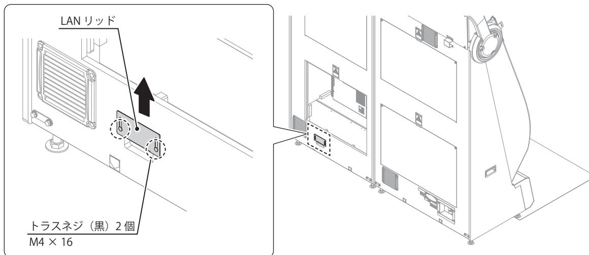
3 「6-3-2-A」手順 3 でサーバー機に接続した LAN ケーブル 10 m の反対側のコネクター 1 個を、クライアント機の穴に通します。
