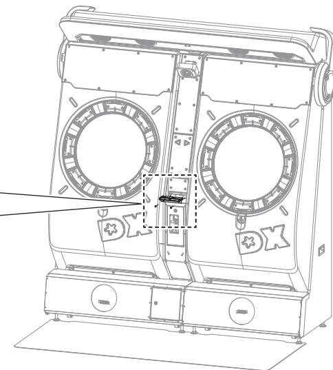
**2** 皿ネジ2個を外し、カードエントリーを取り外します。
